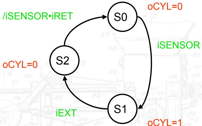
$$cS0 = cS2 \cdot i\text{SENSOR} \cdot i\text{RET} + cS0 \cdot i\text{SENSOR} + /cS0 \cdot cS1 \cdot cS2$$
